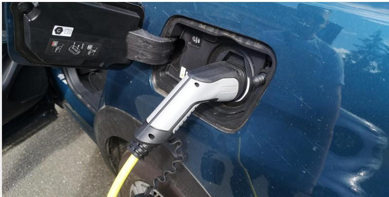
**Vérifier maintenant que le véhicule se recharge bien en observant l'état de la borne et du tableau de bord de la voiture**
